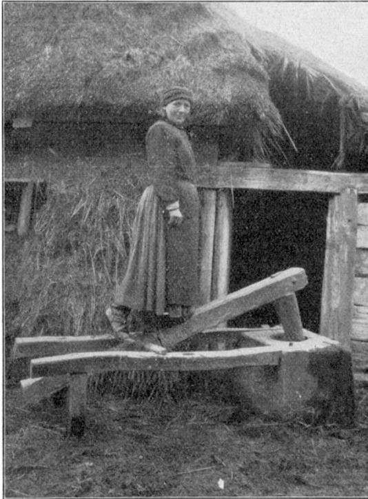
Holzmörser mit Tretvorrichtung. Wolhynien.
